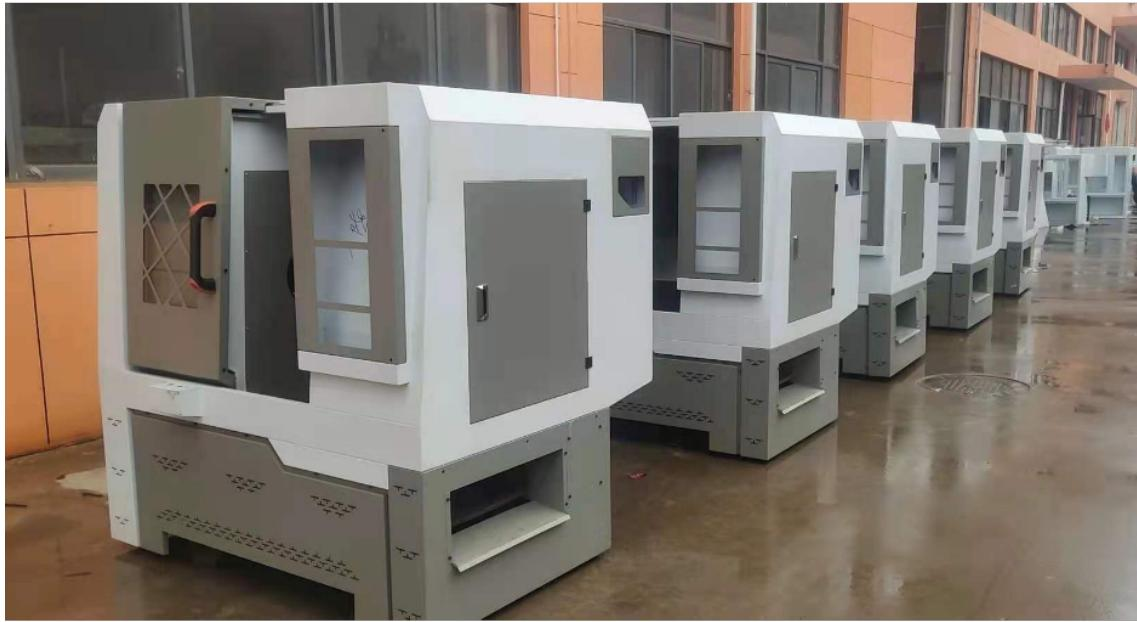
斜轨机床防护罩在设计方面，很是合理方便，能经受撞击和炽热碎片，引起的+900℃高温。然而在结构和布局应设计方面，使操作员不能直接进入危险区域，为防止指尖误通过，而造成伤害时斜轨机床防护罩其开口宽度是可以设置的。在斜轨机床行业的高速发展下，防护罩也随之发展，甚是迅速，因此防护罩在斜轨机床行业的地位也越来越重要。大多数在生活中的防护罩，往往都是会被运用到斜轨机床上的。能够被安装在斜轨机床上的防护罩往往呈现出怎样的效果。安装在斜轨机床上时，防护罩在工作的时候就算是出现了碰撞，那么它自身也不会就此呈现变形的效果。
